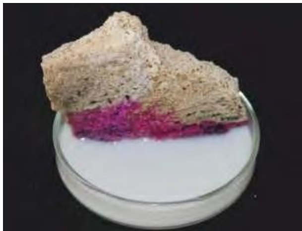
Фигура 5: Фенолфталеин, индикиращ дифузията на CaloSIL ® E25 в проба от пореста мазилка.
